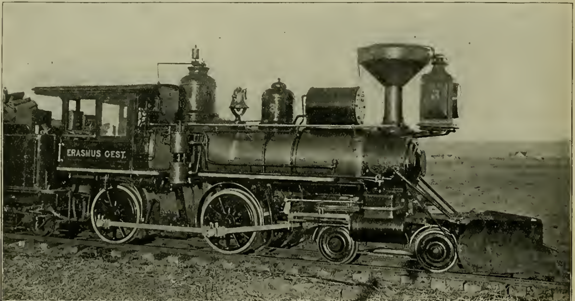
N., C. & O. R. R. ENGINE, WITH MAIN RESERVOIR ON TOP OF BOILER.
